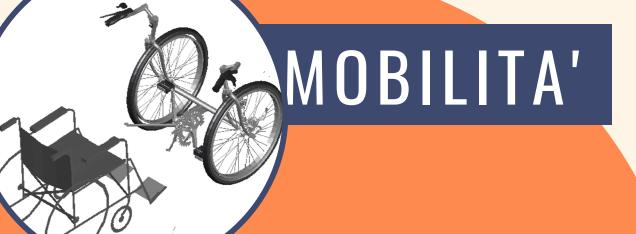
Utilizzando un gancio per unire la carrozzina al nostro design, possiamo trasformare una carrozzina in una bicicletta in modo sicuro e semplice. Questo fa si' che il nostro progetto sia user-friendly. L'utilizzatore puo' facilmente passare dal guidare una bicicletta a muoversi su sedia a rotelle in qualsiasi momento
