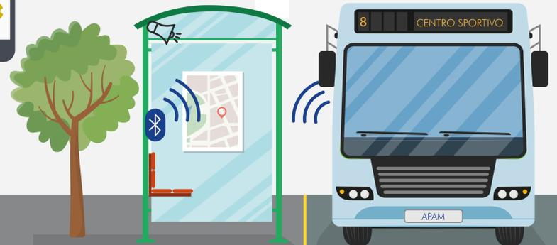
Per avvisare anche l'autista della presenza alla fermata di una persona con difficoltà visive, si potrebbe installare sull'autobus un sistema di comunicazione con il server APAM, che attivi un segnale visivo sul display del mezzo.
